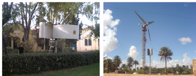
Figure 2: Eolienne à axe vertical de démonstration (prototype) et celle installée au voisinage de la vétérante d'ADRAR. (INRAA).
